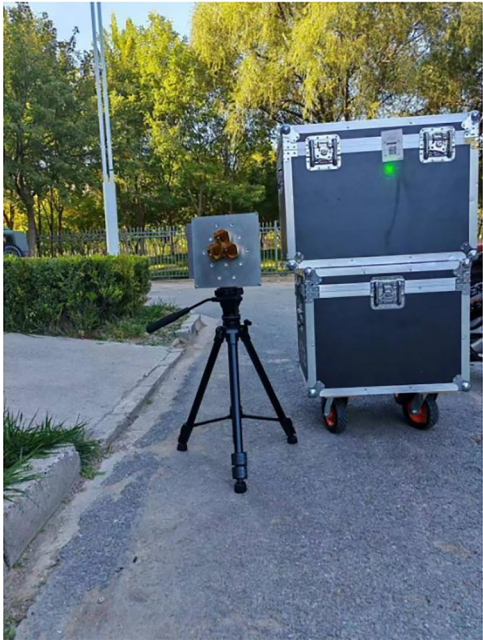
图 17 末端采用空心反射器 Fig. 17 Hollow reflector at terminal
